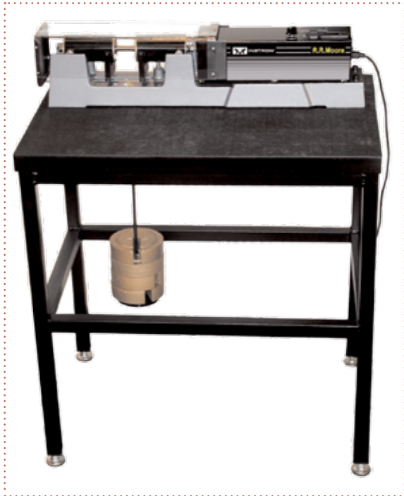
Figura 10 a. Máquina de ensayo de fatiga tipo probeta de Moore. Fuente [16]
