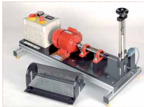
Figura 10 b. Máquina de ensayo de fatiga tipo viga en voladizo. Fuente [15]
